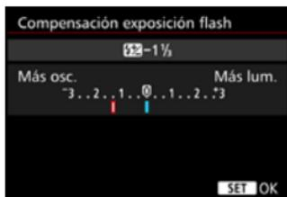
Puede establecer la compensación de la exposición con flash hasta  $\pm 3$  puntos en incrementos de  $1/3$  de punto.
