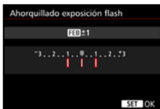
Mientras se cambia automáticamente la potencia del flash, se realizan tres disparos.
