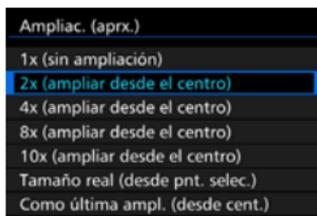
Bajo la ficha [▶3], cuando seleccione [Ampliac. (aprx.)], podrá ajustar la ampliación y la posición inicial para la vista ampliada.
