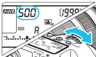
2 **Ajuste la velocidad de obturación deseada.**
