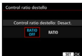
Con un flash macro (MR-14EX II, etc.) compatible con los ajustes de las funciones del flash externo, puede ajustar el ratio de flash entre tubos del flash o las cabezas de flash A y B, o utilizar el flash inalámbrico con unidades secundarias.
