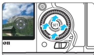
Solo tiene que tocar la parte superior, inferior, izquierda o derecha de <[**📷+**]> para realizar operaciones silenciosas. Durante la grabación de vídeo, puede presionar el botón <[**Q**]> para mostrar la pantalla de control rápido y cambiar las funciones siguientes con <[**📷+**]>.
