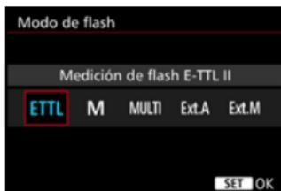
**[Medición de flash E-TTL II]** es el modo estándar de los flashes Speedlite serie EX para el disparo con flash automático. **[Flash manual]** es para que usted realice sus propios ajustes de **[Nivel de potencia del flash]** del flash Speedlite. Respecto a otros modos del flash, consulte las Instrucciones de un flash Speedlite compatible con las funciones.
